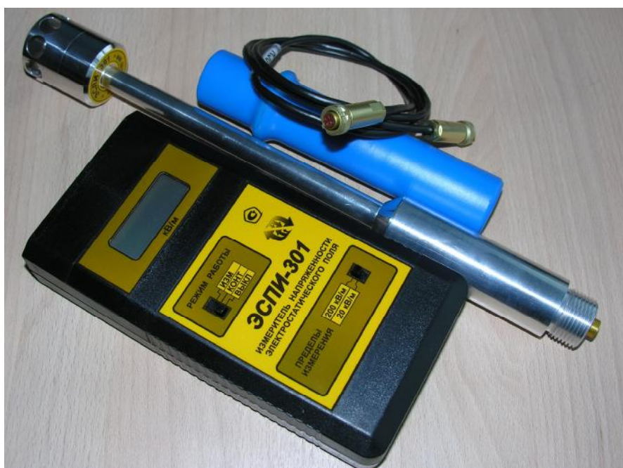
Рисунок 1 — Внешний вид измерителей напряженности электростатического поля ЭСПИ-301
